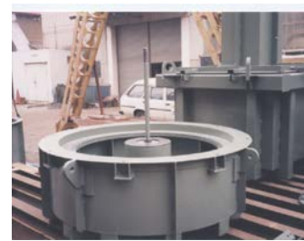
原子力発電用遮蔽容器 内面:鉛 casting 込み
