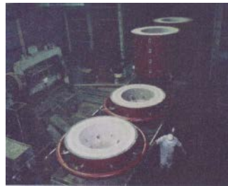
電力発電用耐火炉 内面:耐火煉瓦貼り
